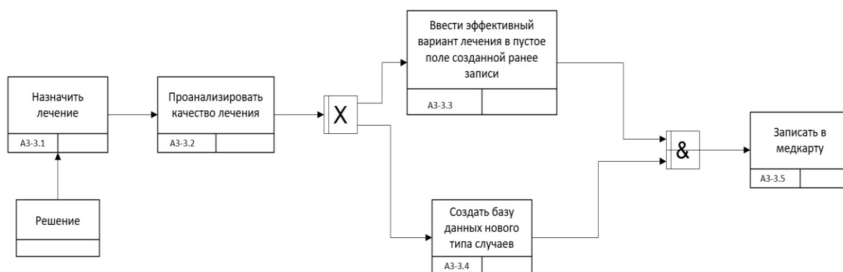
Рис. 5.10. Процесс А3-3 в нотации IDEF3 и модели TO-BE
